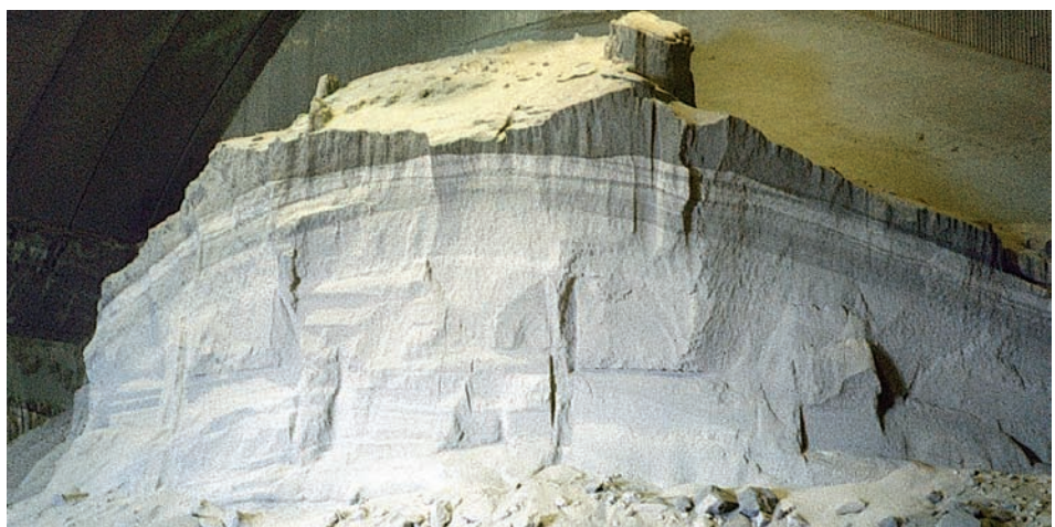
Apelmazamiento en una pila de material a granel.
